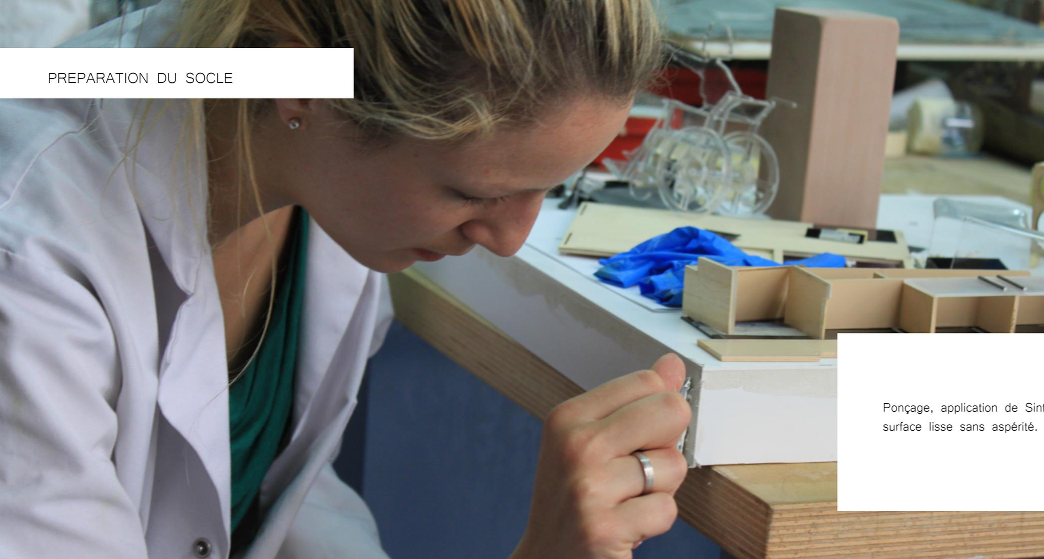
Ponçage, application de Sintofer puis d'apprêt peinture jusqu'à l'obtention d'une surface lisse sans aspérité.
